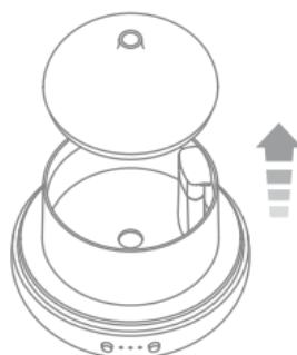
3. Rellene el depósito de agua hasta el punto deseado sin superar la marca MAX.
